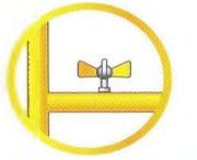
закрывать кран на отводе к газовым приборам
